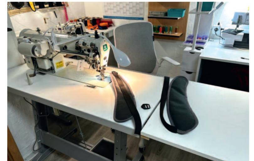
Auch die Rucksack-Gurte werden aus Einzelteilen zusammengesetzt und vernäht.
